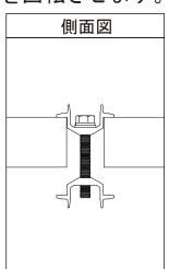
③雪止め金具(上部)ごと引張り上げ雪止め金具(下部)が太陽電池 モジュールのフレームに引っ掛かっていることを確認します。
