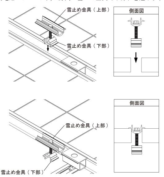
②ボルトの頭を90度回し雪止め金具(下部)を回転させます。
