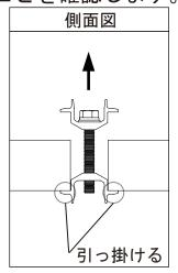
④雪止め金具(上部)を引張り上げた状態でボルトを締込み固定します。
