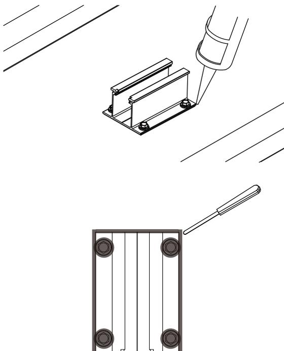
金具の — 部分3辺とビス頭・ビスまわりをゴムアス系コーキング材で防水処理し、ヘラを使用し整えます。
