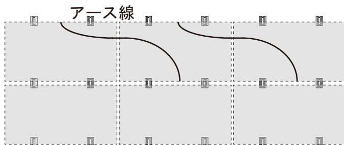
太陽電池モジュールの縦（段）方向はスペース金具で導通を取れますが、横（列）方向は導通が取れないため太陽電池モジュールのアース穴を使いアース線で繋いでアースを取ります。
